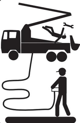
**Diese Maschine ist ferngesteuert und kann zu jedem Zeitpunkt starten. Vor Reparaturarbeiten Motor stoppen.**
